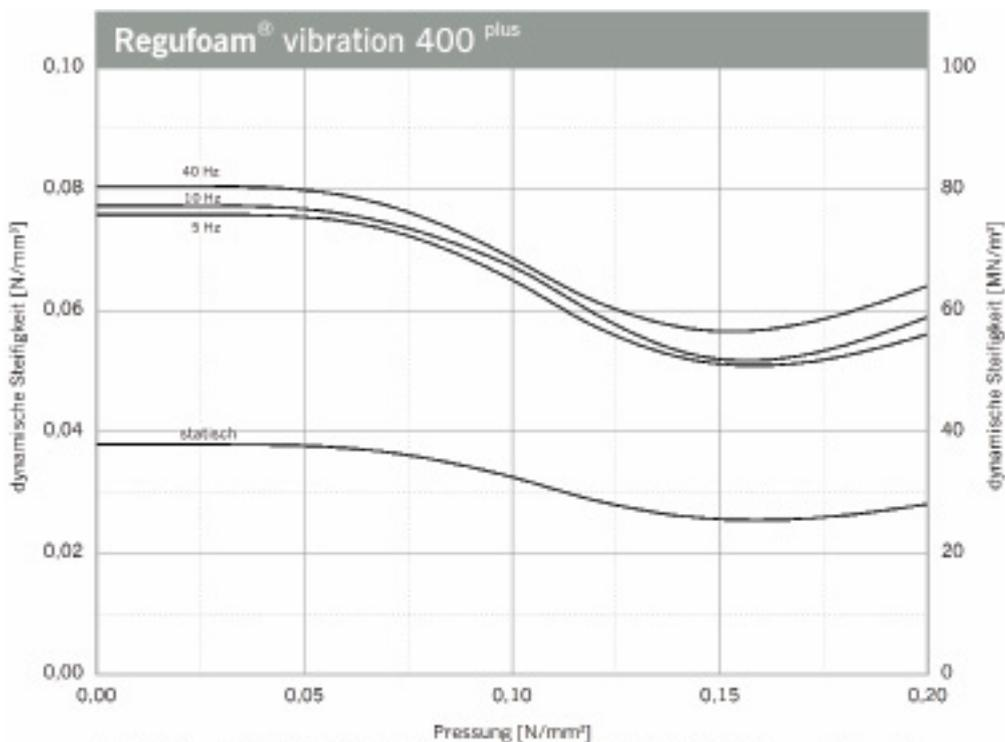
Verlauf der dynamischen Steifigkeit bei sinusförmiger Anregung um eine konstante Mittelast, Wegamplitude + 0,25 mm. Probenabmessung 300 mm x 300 mm x 25 mm; Statische Steifigkeit als Tangentenmodul aus der Federkennlinie. Messung in Anlehnung an DIN 53513.
