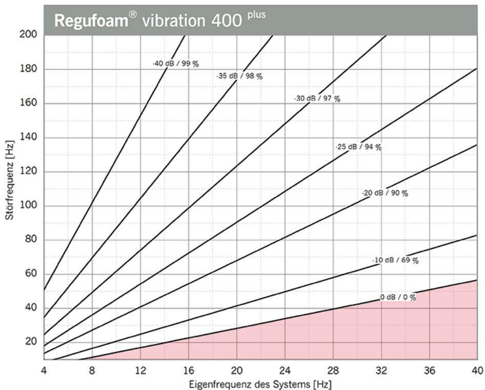
Dargestellt ist die Isolierwirkung für einen Ein-Massen-Schwinger auf starrem Untergrund mit **Regufoam® vibration 400 plus**.
