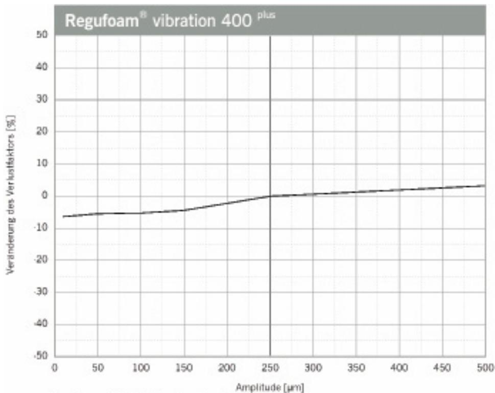
Veränderung des Verlustfaktors aufgrund geänderter Anregungsamplitude. Sinusförmige Anregung bei konstanter Mittelast von 0,11 N/mm<sup>2</sup>, Probenabmessung 300 x 300 x 25 mm.
