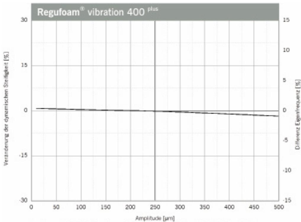
Veränderung der Steifigkeit aufgrund geänderter Anregungsamplitude. Mittelwert für 5 Hz, 10 Hz und 40 Hz Anregung. Sinusförmige Anregung bei konstanter Mittellast von 0.11 N/mm<sup>2</sup>, Probenabmessung 300 x 300 x 25 mm. Eigenfrequenz für einen eindimensionalen Feder-Masse-Schwinger auf starrem Untergrund.
